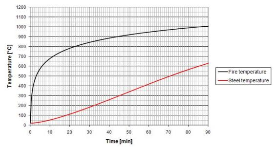
*Figur 1: Oppvarming av stålbjelke (nederste kurve) som følge av brannpåvirkning fra en standard ISO 834 tid-temperaturkurve*
